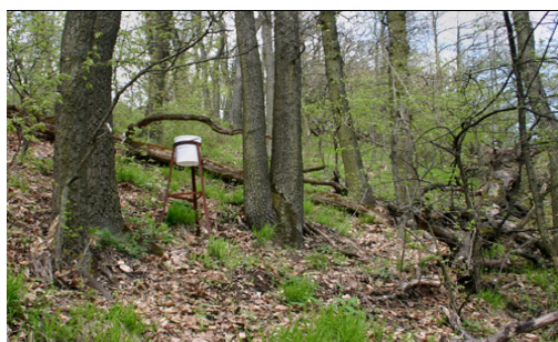
Obr. 2 Celkový pohľad na záchytné zariadenie pre kvapalné zrážky na ploche DB-J (foto: V. Kunca, 24. 4. 2008)
