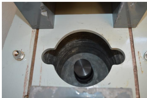
Obr. 2 Scintilačný NaI(Tl) spektrometrický systém s detektorom v tieniacom kryte Fig. 2 Scintillation NaI(Tl) spectrometry system with detector in the background shielding
