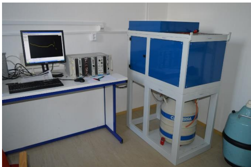
Obr. 1 Polovodičový HPGe spektrometrický systém s detektorom v tieniacom kryte Fig. 1 Semiconductor HPGe spectrometry system with detector in the background shielding
