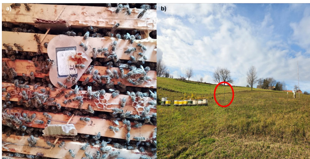
Obr. 1 Použité zariadenia na zber dát. a) „Srdce úľa“ na meranie vnútorných podmienok, b) Meteorologická stanica Fig. 1 Equipment used for data collection. a) "Heart of the hive" for measuring internal conditions, b) Meteorological Station
