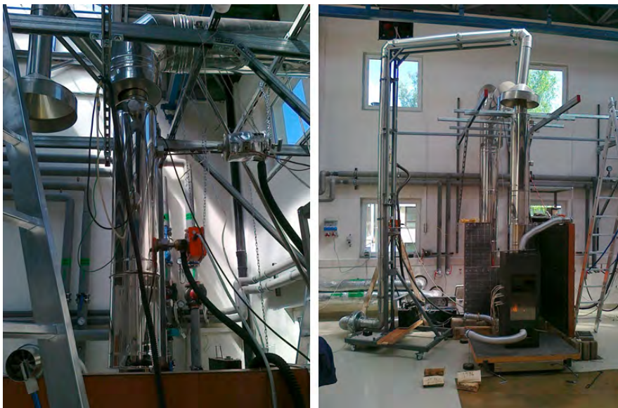
Obr. 5 Merací úsek v komíne vľavo, zried'ovací tunel vpravo
