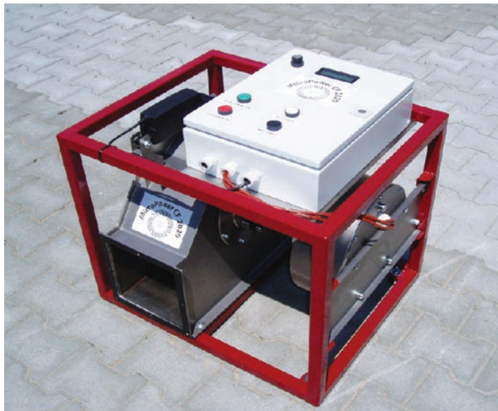
Obr. 8. Funkčný model mikrozdroja elektrickej energie s výkonom do 1500 W
