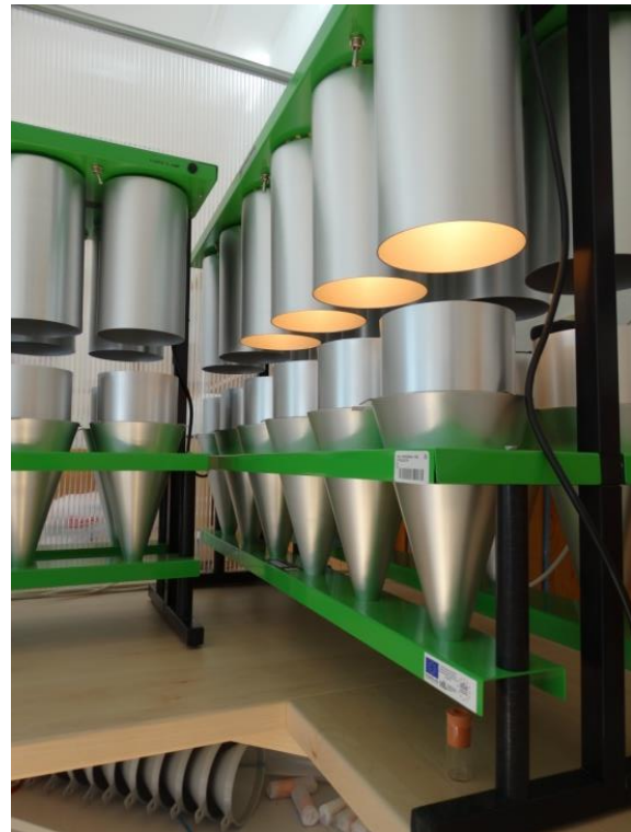
Fotoeklektory určené na „vyháňanie“ pôdných organizmov zo substrátu
