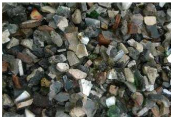
Obr. 3 Granulát z popola 8 – 16 mm (Keulen et al., 2016)
